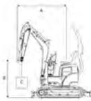
Macchina con cingoli in gomma, benna da 16,5 kg (350 mm).
